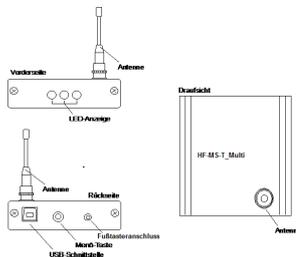
Abmessungen: 20 mm x 84 mm x 72 mm (H x T x B) ohne Antenne
