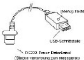
Abmessungen: 12mm x 83mm x 21mm (H x T x B, ohne Signalkabel) Gewicht: ca. 22g (ohne Signalkabel)
